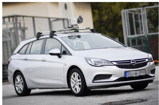
Abb. 4 Die Netze Duisburg GmbH nutzt seit 2017 ein Einsatzfahrzeug, das mit einer Wärmebildkamera ausgestattet ist.
