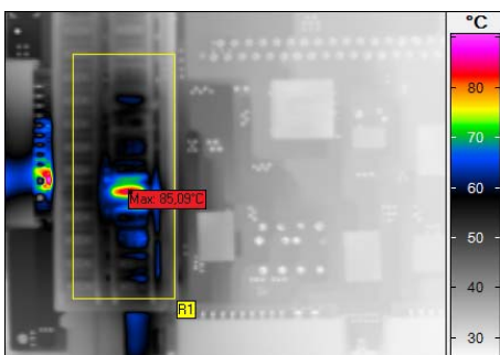
Abb. 2: 5x Digitalzoom eines Wärmebilds mit Fuse block
