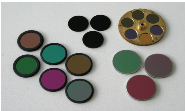
Abb. 4 Spektralfilter für Thermografiekameras
