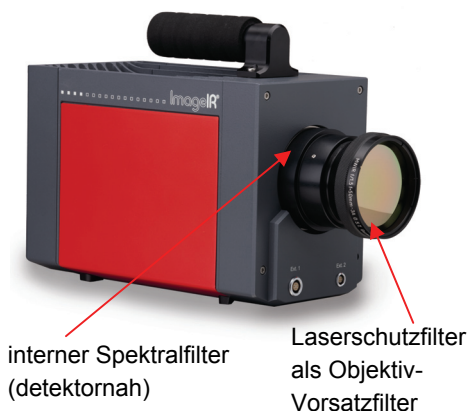
Abb. 1 High-End-Kameraserie ImageIR® mit motorisiertem Filterrad (4 Positionen)
