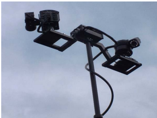
CCTV-System mit Wärmebildkamera VarioCAM® hr head 620
